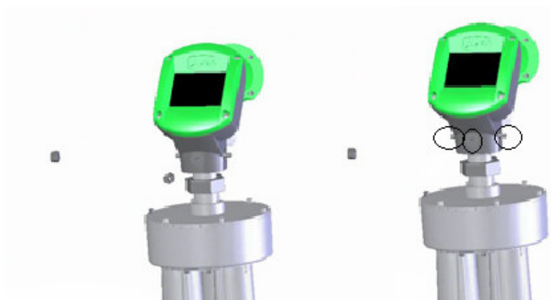
Abbildung 15: Lösen der Muttern und Schrauben am Scannerkopf
