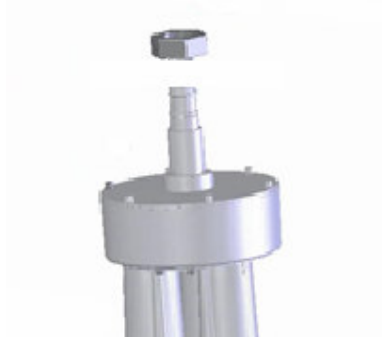
Abbildung 18: Entfernen der Befestigungsmutter vom Rohr
