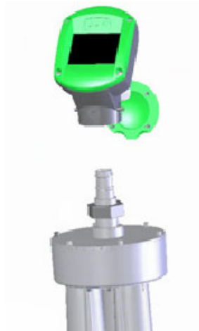
Abbildung 16: Entfernen des Scannerkopfes vom Rohr
