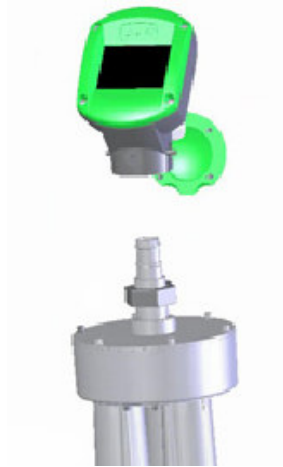
Figura 16, extracción del medidor del tubo del cuello
