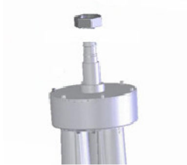
Figura 18, extracción de la tuerca del tubo de conexión
