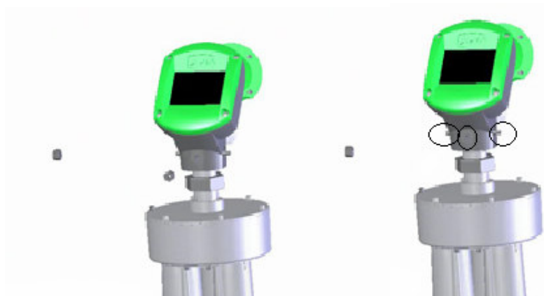
Figura 15 Estrazione di dadi e viti dalla testa dello scanner
