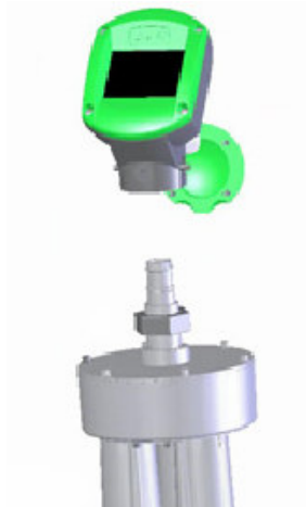
Figura 16 Estrazione dello scanner dal tubo a collo
