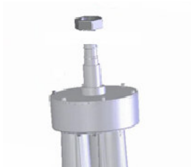
Figura 18 Estrazione del dado dal tubo a collo
