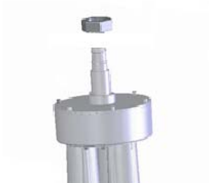
Figure 18 Dépose du boulon du col du tube
